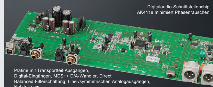
Auf guten Klang und hohe Zuverlässigkeit selektierte Bauteile USB-Chip USB-Buchse
