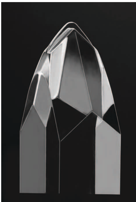
Der Microridge-Schliff des Abtastdiamanten in voller Pracht
