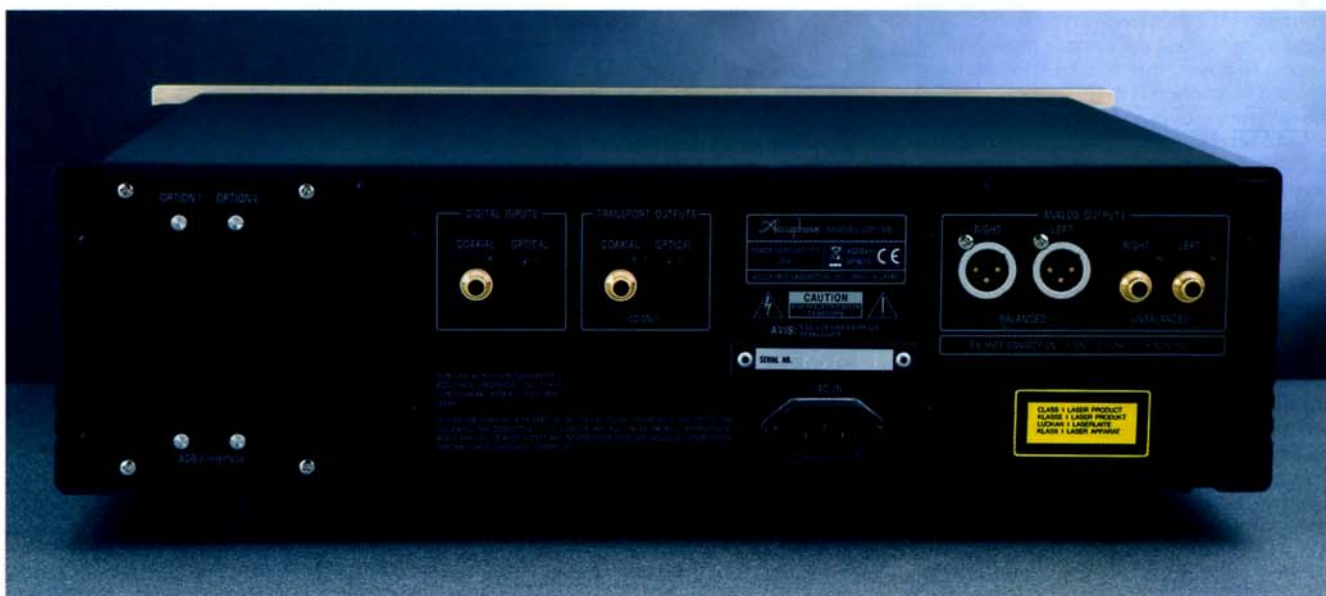
Sul pannello posteriore si notano gli insoliti ingressi digitali, con connettore coassiale e ottico, che consentono di utilizzare la sezione D/A dell'apparecchio anche con sorgenti digitali esterne. Si notino anche i due connettori relativi alle uscite analogiche bilanciate e, sul lato sinistro, le due piastrine rettangolari di chiusura che celano i vani nei quali possono essere inseriti i moduli opzionali.
