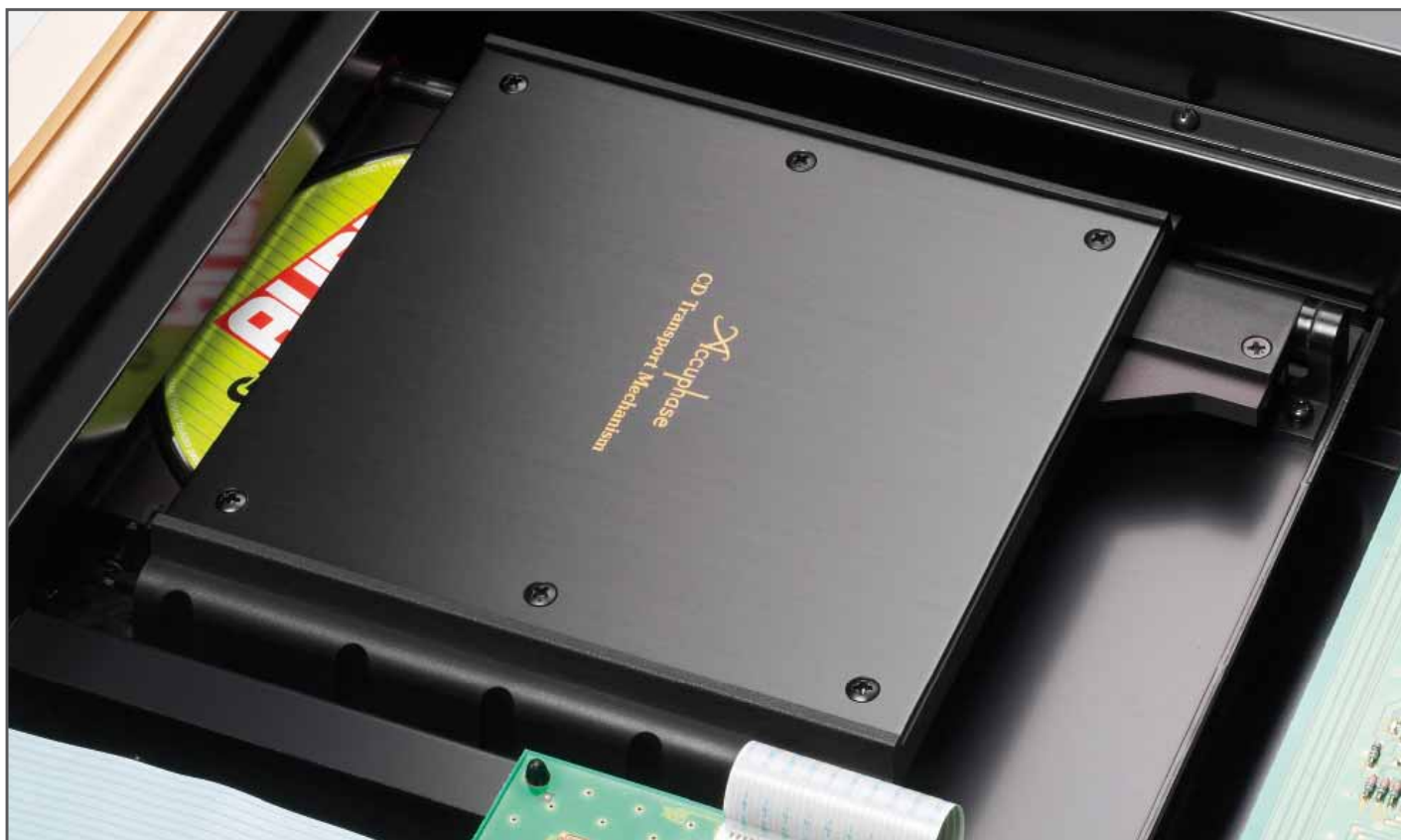
Massive Mechanik: Die Laufwerk-Basis ruht auf einem stabilen Metallrahmen. Die Abtasteinheit ist unter der Brücke schwimmend montiert.
