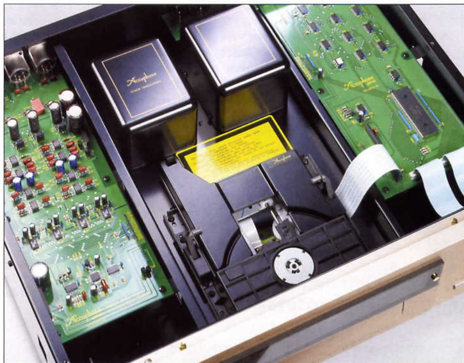
Der Innenaufbau des DP-67 wirkt wie gelehrt: kurze Signalwege, sorgsam separierte Kamern für Steuerung und Signalaufbereitung, allerfeinste und zugleich robuste Mechanik.
