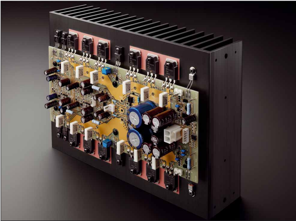
Das ist das Mono-Endstufenmodul des E-800. Ein Dutzend Mosfets sorgt für die Ausgangsleistung
