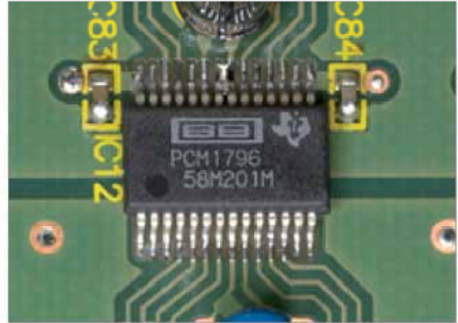
Gleich vier dieser Wandler arbeiten parallel, um das Verhältnis zwischen Konversionsfehlern und Signal zu verbessern
