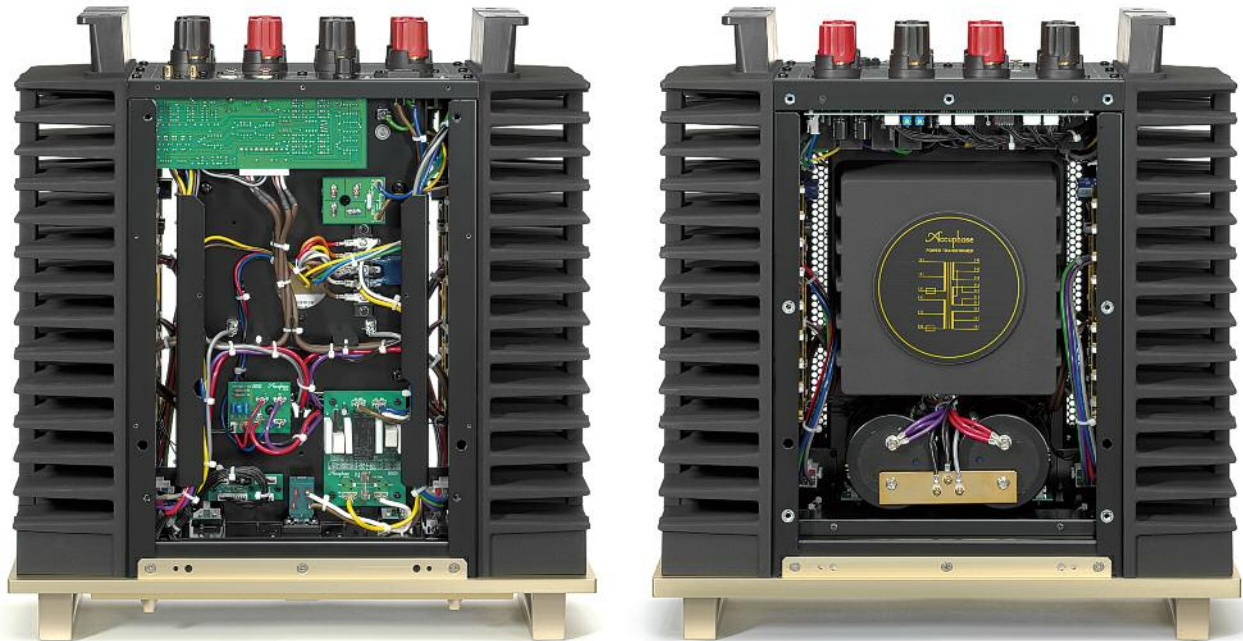
P-6100 kopfüber: links die Spannungsversorgung und symmetrische Signalführung von der Eingangsplatine (links oben), rechts ein mächtiger, gekapselter Trafo, flankiert von der Verstärkerschaltung
