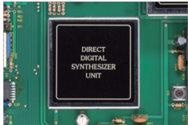
Sämtliche in Bezug auf Ab- und Einstrahlung kritischen Stellen in der T-1000 Topologie sind wirksam abgeschirmt
