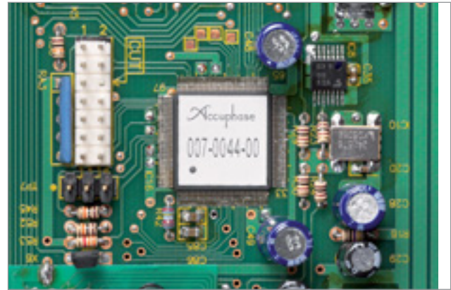
Neue Möglichkeiten auf digitaler Ebene: Die Stereo-DEM-Modulation findet nun in einem Signalprozessor statt
