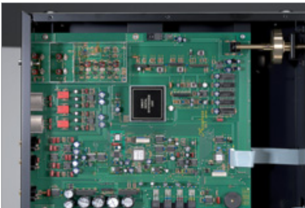
That's all, folks: Der Rest des großen Gehäuses gehört dem völlig abgeschimten Netzteil. Leistungsaufnahme: 17 Watt
