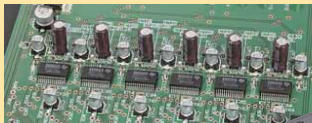
Im DP-510 arbeiten gleich sechs Wandler-Chips von Texas Instruments parallel, was die Fehlerrate um mehr als den Faktor zwei reduzieren soll
