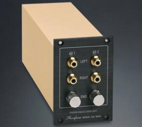
Le AD-2850 est un préampli phono conçu pour les préamplificateurs C-2850/ C-2450, afin de permettre la reproduction des disques vinyles. Le module est installé dans un emplacement optionnel spécial situé sur le panneau arrière. Les niveaux d'entrée séparés optimisés pour les cellules MC et MM permettent de disposer des meilleures performances pour toutes les cellules. Toutes les fonctions (gain AD et impédance d'entrée MC) sont actionnées à l'aide des commandes en façade du C-2850 ou du C-2450.
