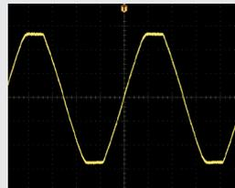
Foto (b) Strom-Wellenform des Netzanschlusses (ca. 3% Klirr)
