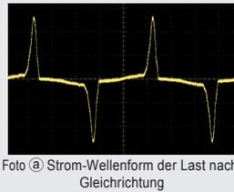
Foto (a) Strom-Wellenform der Last nach Gleichrichtung
