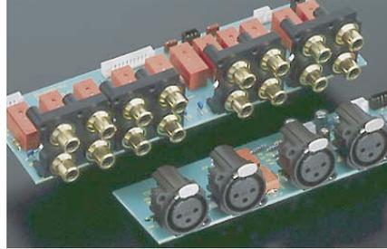
hermetisch versiegelten Relais wurden für äußerst anspruchsvolle Kommunikationsanwendungen entwickelt und zeichnen sich durch überragende Qualität aus. Doppelte, goldbeschichtete Kreuzschienen minimieren den Kontaktwiderstand und bieten überlegene Langzeit-Zuverlässigkeit.
