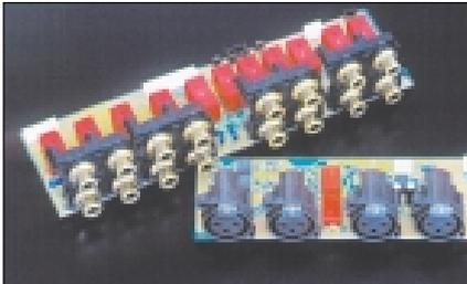
Direkt mit vergoldeten Ein- und Ausgangsbuchsen verbundene Relais
