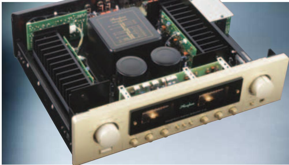
**UNDANKBARES OBJEKT FÜR RESONANZJÄGER:** Wegen des mechanisch perfekten Aufbaus des E 213 vibriert, mikrofoniert oder sirt nichts. Sogar die Kühlrippen sind bedämpft.
