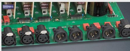
Symmetrische Eingangs- und Ausgangsanschlüsse
