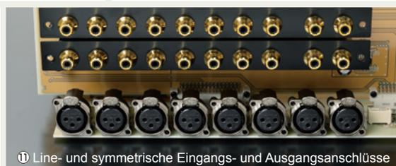
⑪ Line- und symmetrische Eingangs- und Ausgangsanschlüsse
