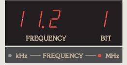
Anzeige der Abtastfrequenz und Quantisierungs-Bitzahl
