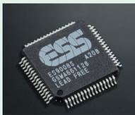
Im DP-550 kommen vier Hyperstream™ DAC-Chips (ES9008 von ESS Technology Inc.) in Parallelschaltung zum Einsatz. Im Vergleich zu einem einzelnen Wandler ergibt dies eine Leistungsverbesserung um einen Faktor von 2 ( $=\sqrt{4}$ ). Da die durch das MDS-Prinzip erzielte Leistungsverbesserung nicht von Signalfrequenz oder -pegel abhängig ist, können auch Störkomponenten bei sehr niedrigen Pegeln, welche für herkömmliche Delta-Sigma-Wandler ein Problem darstellen, zuverlässig reduziert werden.
