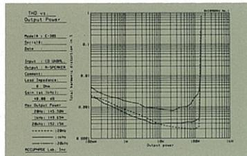
● Ausgangsleistung im Verhältnis zum Klirrfaktor (8 Ohm Last)
