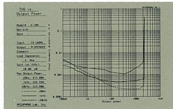
● Ausgangsleistung im Verhältnis zum Klirrfaktor (4 Ohm Last)
