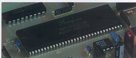
Microcomputer zur Kontrolle des Schaltpunktes
