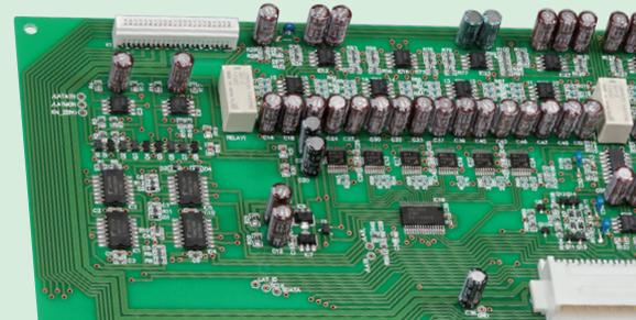
Logikgesteuerte Relais mit Line-Eingangs- und Ausgangsanschlüssen
