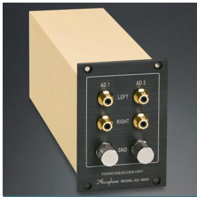
Die speziell für die Vorverstärker C-2850 und C-2450 konzipierte Phono-Equalizer-Einheit AD-2850 erlaubt die Wiedergabe von analogen Schallplatten. Die Einheit wird in einem dafür vorgesehenen Einschub auf der Geräterückseite installiert. Separate Eingangskreise für MC und MM Tonabnehmer holen das Beste aus jedem Tonabnehmermodell heraus. Alle Funktionen (AD-Verstärkungsfaktor und MC-Eingangsimpedanz) werden mit Bedienelementen auf der Vorderseite des C-2850 oder C-2450 kontrolliert.
