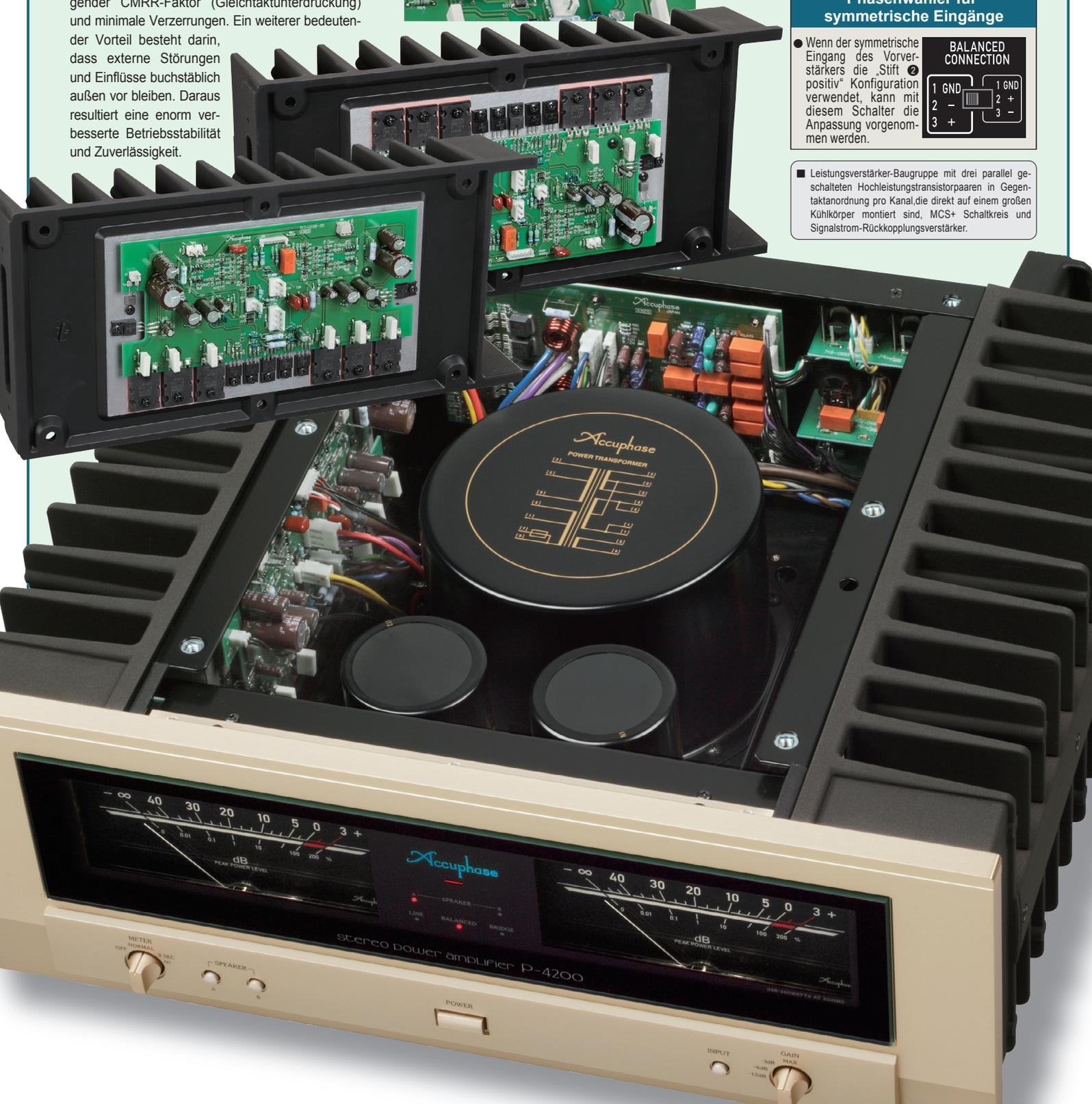
■ Für noch höhere Qualität können zwei P-4200-Einheiten im Brücken-Modus oder in einer Bi-Amping-Konfiguration verwendet werden. ■ In diesem Fall benutzt man nur die linken (LEFT) Eingänge (BALANCED oder LINE) beider Verstärker.
