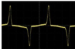
Foto (A) Strom-Wellenform der Last nach Gleichrichtung
