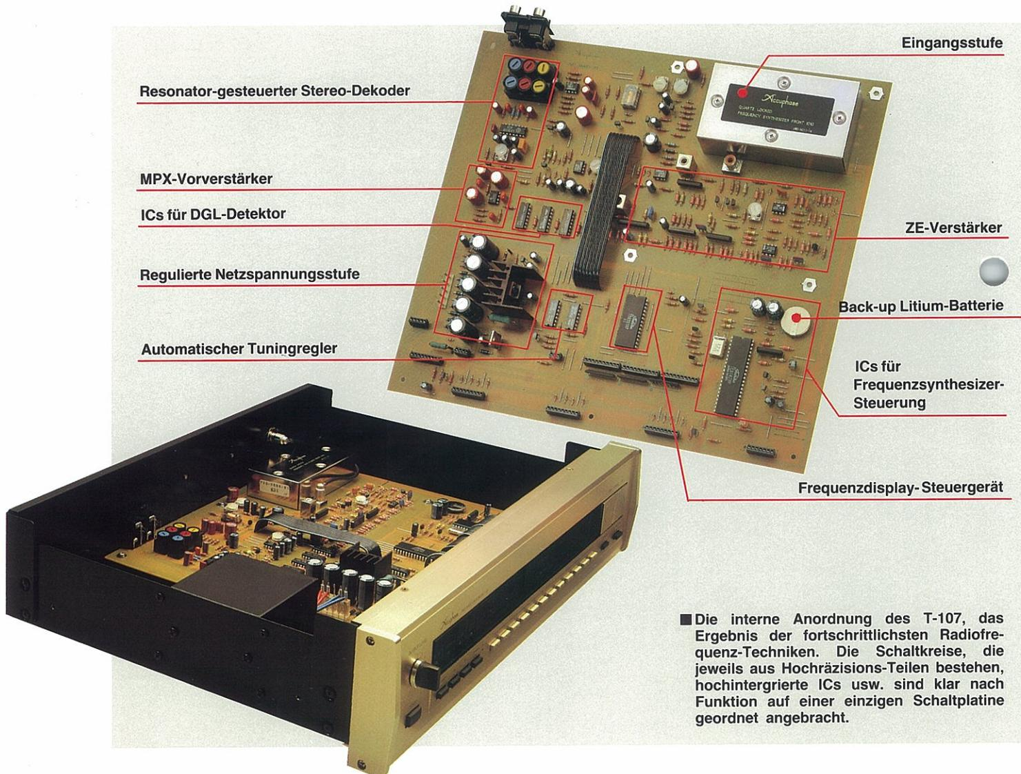
■ Die interne Anordnung des T-107, das Ergebnis der fortschrittlichsten Radiofrequenz-Techniken. Die Schaltkreise, die jeweils aus Hochpräzisions-Teilen bestehen, hochintegrierte ICs usw. sind klar nach Funktion auf einer einzigen Schaltplatine geordnet angebracht.
