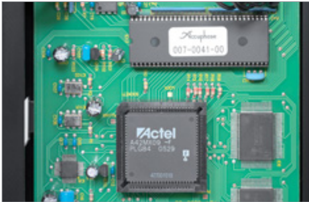
Made by Accuphase: Laufwerksteuerung mithilfe eines Signalprozessors, günstig vor allem bei hohen Abtastraten
