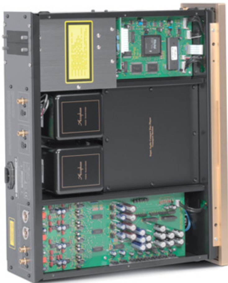
Laufwerk unter Dach und Fach, Trafos gekapselt, Signalverarbeitung aufgeräumt: Der DP-78 ist prallvoll und wohlgeordnet, japanische Ingenieurskunst vom Feinsten
