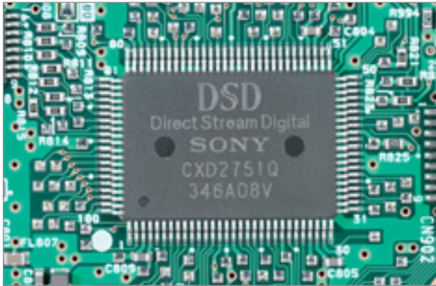
Auf DSD-Ebene arbeitet der Accuphase DP-78 mit einer 2,8224-MHz/1-Bit-Wandlung
