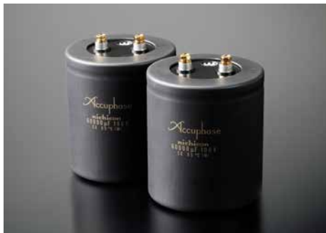
Rechts geht der den Blick in den geöffneten Patienten. Das Innenleben der P-7500 wird zu gefühlten 99,9 Prozent vom Netzteil eingenommen. Die Detailfotos oben zeigen den isolierten, im Aluminiumkorpus gekapselten Ringkerntrafo sowie die beiden riesigen Kondensatoren mit jeweils 60 000 Mikrofarad Siebkapazität.
