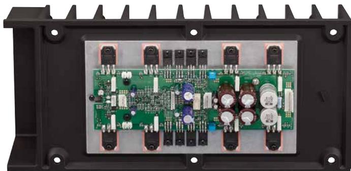
Zusammen mit den acht Endtransistoren – vier pro Halbwellen in Gegentaktschaltung – sitzt die komplette Leistungselektronik auf den Kühlkörpern.
