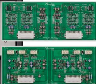
Der strikt nach Funktionsgruppen geordnete Vorverstärker läuft mit zwei Netzteilen im echten Doppel-Mono-Betrieb. Die Elektronik verteilt sich nach Aufgaben geordnet streng kanalgetrennt auf fünf Steckplatinen wie diese rechts.
