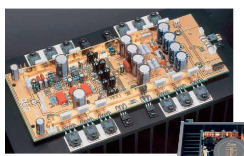
Ein Kanal eines praktisch perfekten Hochleistungsverstärkers: Zwölf Endtransistoren plus "MCD"-Eingangsstufe besorgen die Verstärkung
