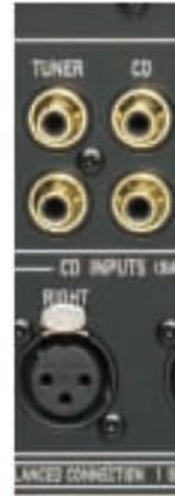
Der E 460 erlaubt auch den Anschluss symmetrischer Kabel. In den Hörtests aber waren die asymmetrischen Cinch-Verbindungen wenigstens ebenbürtig...
