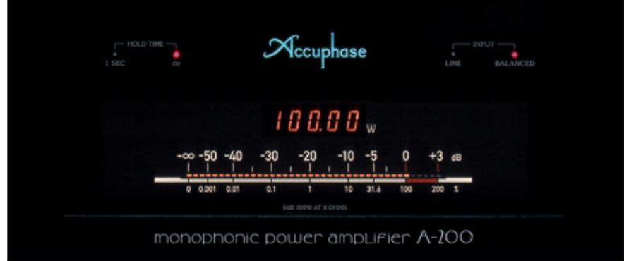
ist diese Stille den parallel arbeitenden Ausgangsstufen und dem diskret aufgebauten Eingangsverstärker, aber auch Änderungen am »Gain-Management«. Früher überließ Accuphase der Eingangs- und Leistungsabteilung einen vergleichbar hohen Verstärkungsfaktor (12 und 16 dB). In der A-200 übernimmt die Eingangsstufe nun den Löwenanteil der Spannungsverstärkung von 22 Dezibel, die Ausgangssection steuert nur noch 6 Dezibel bei. Accuphase verspricht sich von dieser Umverteilung der Auf-
