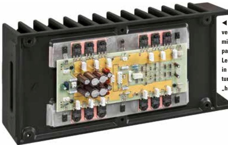
◀ Jeden Kanal verstärkt die A-47 mit jeweils sechs parallel geschalteten Leistungstransistoren in Gegentaktschaltung, also mit zwei „heißen“ Polen.
