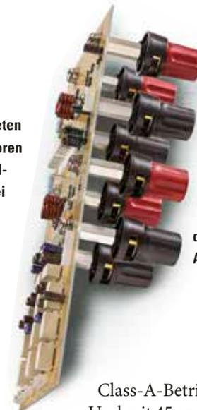
◀ Metallschienen bilden den Kontakt von der Ausgangsplatine zu den groß dimensionierten Anschlussklemmen.
