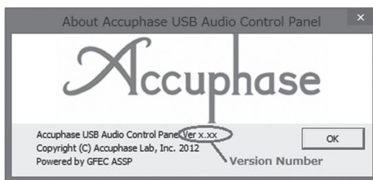
Afb. 6 De versie van de hulpprogramma's controleren (in Windows 8)
