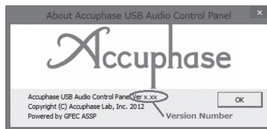
Fig. 6 Controllo della versione del software delle utilità (in Windows 8)
